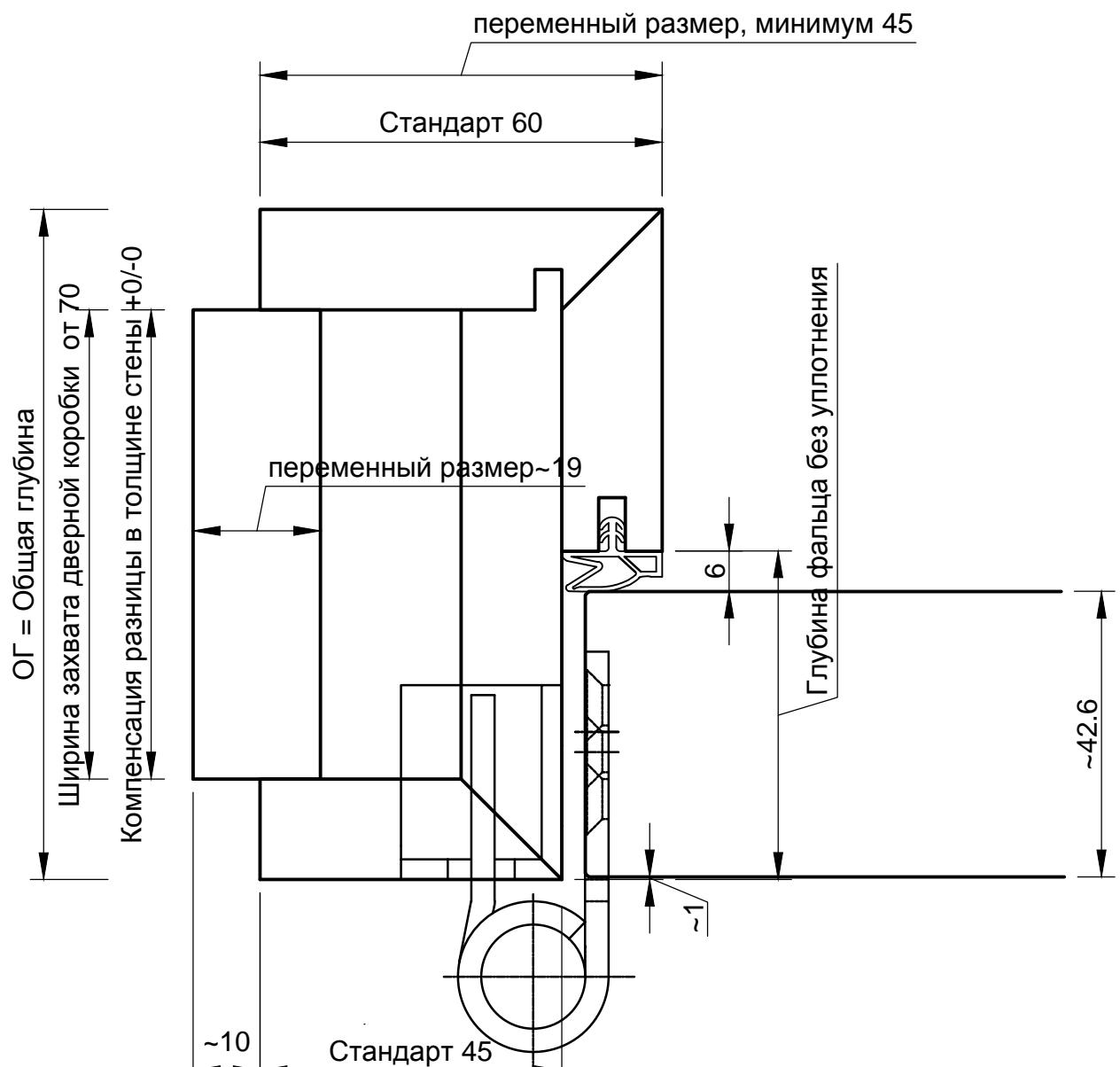
Bekleidungsbreite abhängig von Bandtyp und Einbausituation
